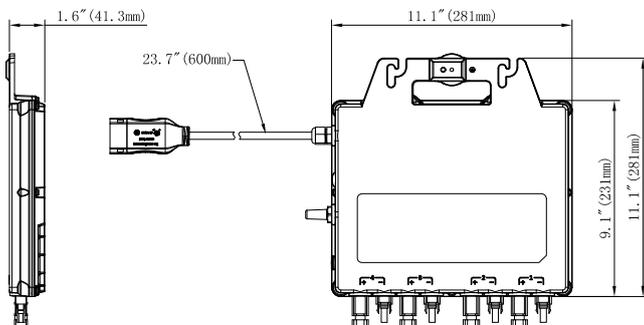
El QS1 microinversor APsystems es de interconexión a la red eléctrica inteligente y sistemas avanzados de monitoreo para asegurar la máxima eficiencia. Alta eficiencia, alta confiabilidad del QS1 con 4 entradas MPPT independientes, la potencia máxima de salida continua es de 1200VA. Un cuarto de los inversores y un cuarto de la instalación significan ahorros de costos reales para clientes residenciales y comerciales.
